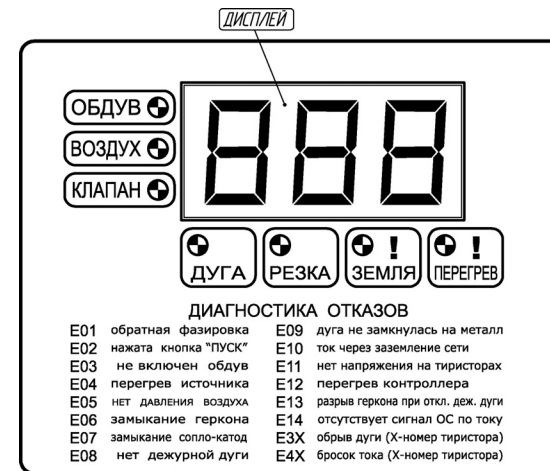
Рисунок 2 Панель управления, зона световой индикации контроллера
